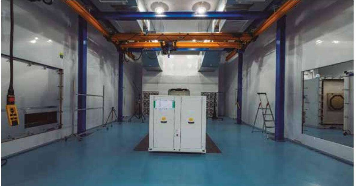
Gráfico 7-4. Sala de ensayo para equipos aire-agua de hasta 100 kW
